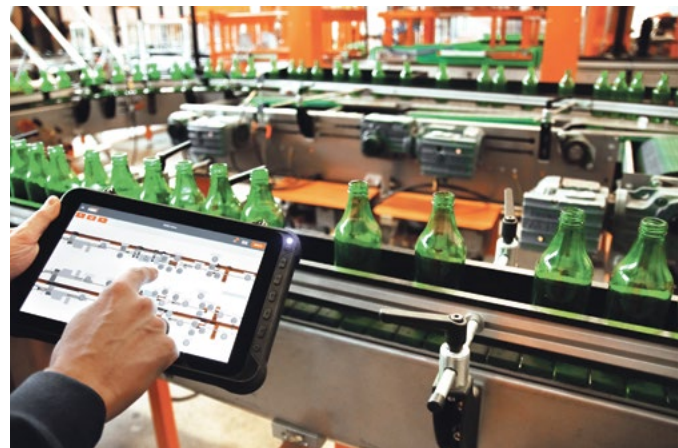
Durch den Einsatz eines modernen Industrietablets bietet MSK EMSY move Mobilität und Sicherheit bei der Bedienung von Nebenstellen einer Anlage
