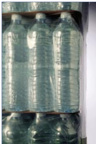
Abb. 8: PET-Flaschen mit optimaler Spannhaut Abb. 8a: eingedrückte PET-Flaschen und Trays durch zu hohe Streckwerte / Druck der Spannhaut Fotos: MSK Verpackungs-Systeme GmbH
