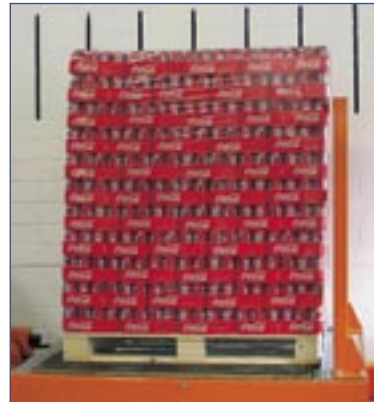
Bild 7 / 7a: max. Auslenkung gestreckte Ladeeinheit (während des Transportversuchs)
