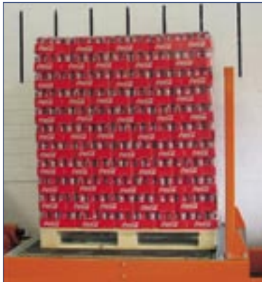
Bild 7 / 7a: max. Auslenkung gestreckte Ladeeinheit (während des Transportversuchs)
